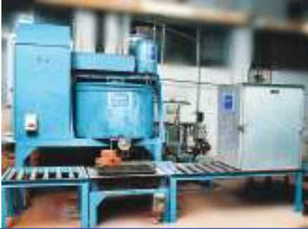
Geopolymer Brick Mini Pilot Plant
